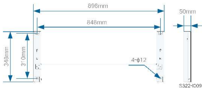
figure 4-1 Dimensions du support de fixation
